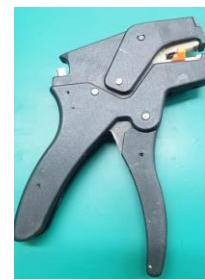
PINZA DESFORRADORA Y CORTADORA
